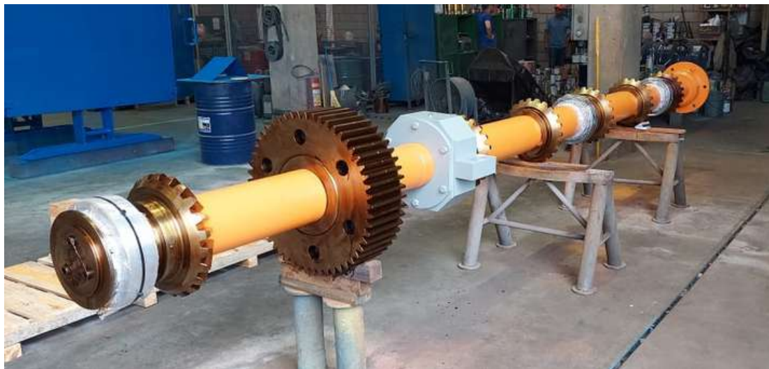
EIXO DE TRANSMISSÃO PARA ESTEIRA DE ROLOS
