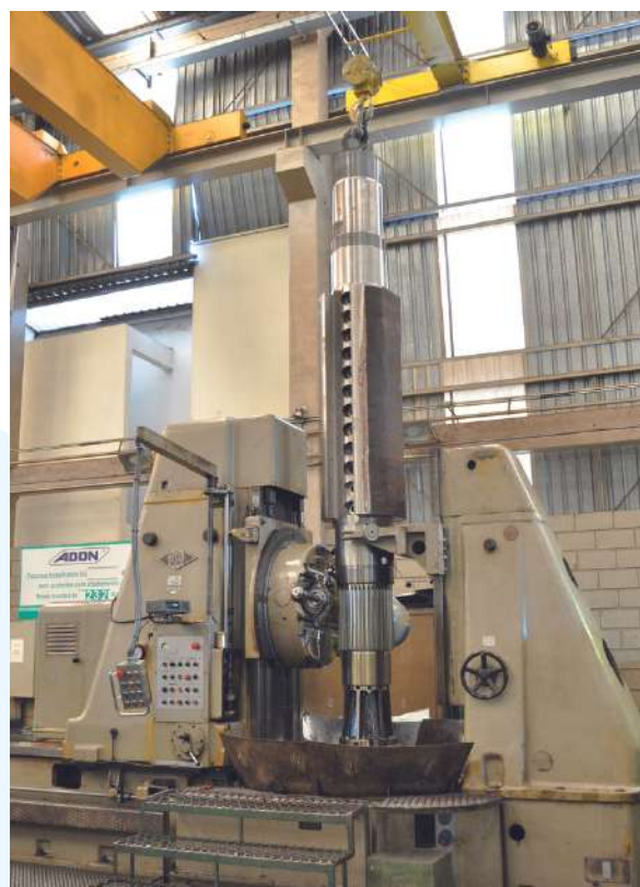
Fresamento de estrias em eixos de grande porte
