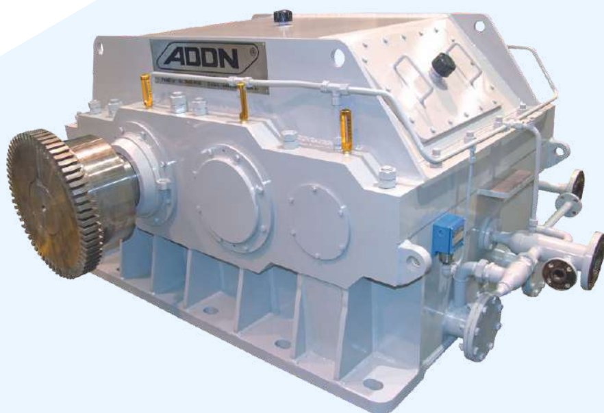
Redutor de 3 eixos para acionamento desfibrador 90"
